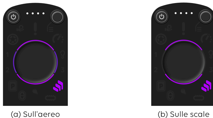
Figura 49. Visualizzazione della modalità scala sulla console di controllo
