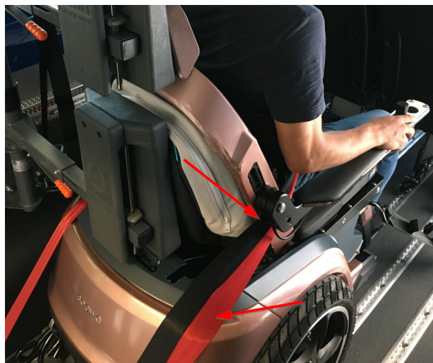
Figura 71. Correggere il percorso della cintura addominale (rossa) e della cintura a 3 punti (nera) per proteggere l'utente
