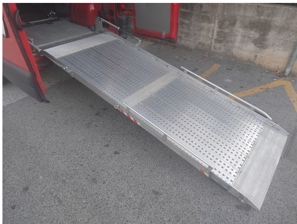
Figura 69. Rampa pieghevole pericolosa e ripida con soglie in alto
