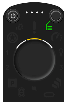
(b) In modalità scala, il motore di regolazione del sedile non è regolabile.
